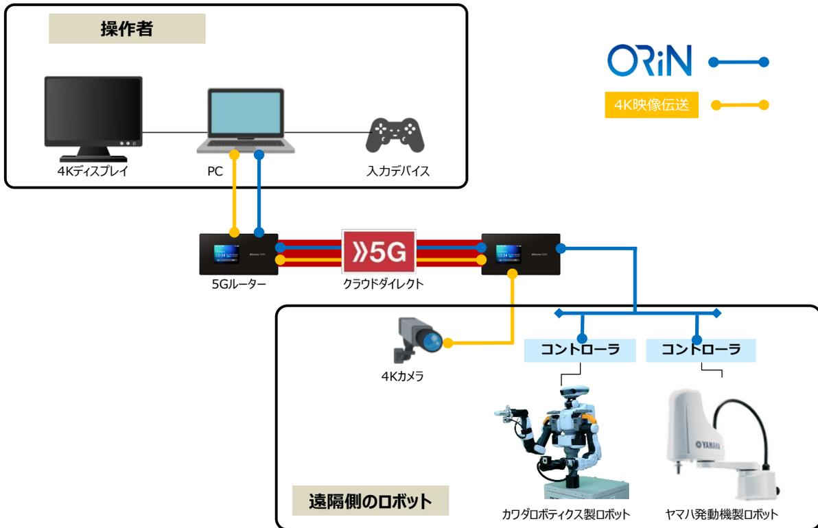
本実証は 5G アンテナが設置されている実験室で実施しました。ロボットの操作者側には、ロボットへ指令入力する入力デバイスと操作用のディスプレイを設置しました。また、遠隔側には制御対象の産業用ロボットとモニタリング用の高解像度 4K カメラを設置しました。操作者側の機器と遠隔側の機器は 5G ルーターとクラウドダイレクトを介して接続しました。
